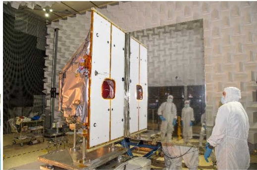
TIRS II EMI/EMC Testing
